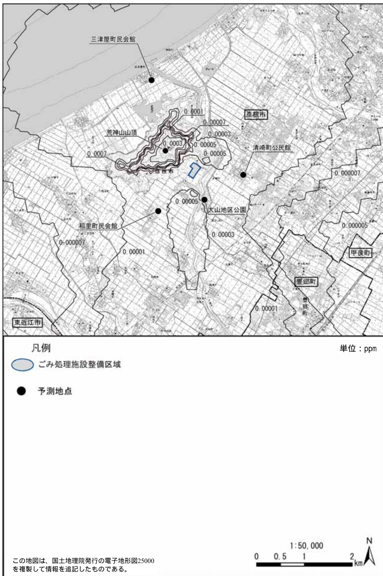
図 3.1-5(2) 長期平均濃度予測結果[二酸化硫黄（寄与濃度）]（拡散幅補正なし:排出ガス影響：大）
