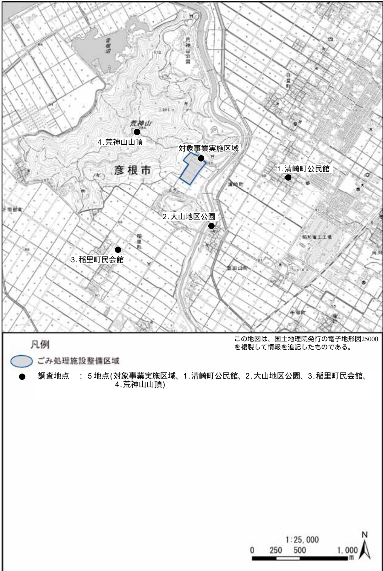
図 8.3-1 超低周波音の現地調査地点
