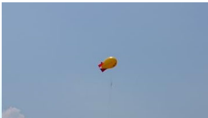
トレーサーガス放出に使用した係留気球
