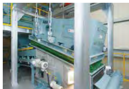
3 磁選機 磁力を使って破砕物の中から鉄類を選別します。
