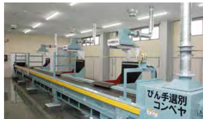
7 びん手選別コンベヤ 手作業によりびんを色ごとに回収します。
