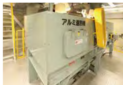
5 アルミ選別機 磁力を使って破砕物の中からアルミを選別します。
