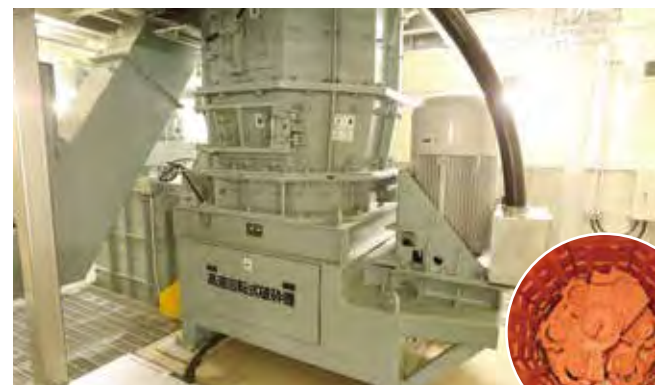
2 高速回転式破砕機 高速回転するリングハンマーでゴミを細かく破砕します。
