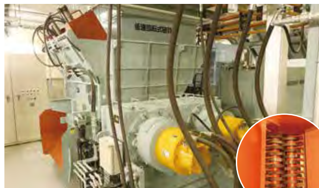
1 低速回転式破砕機 低速回転する刃でゴミを粗く破砕します。
