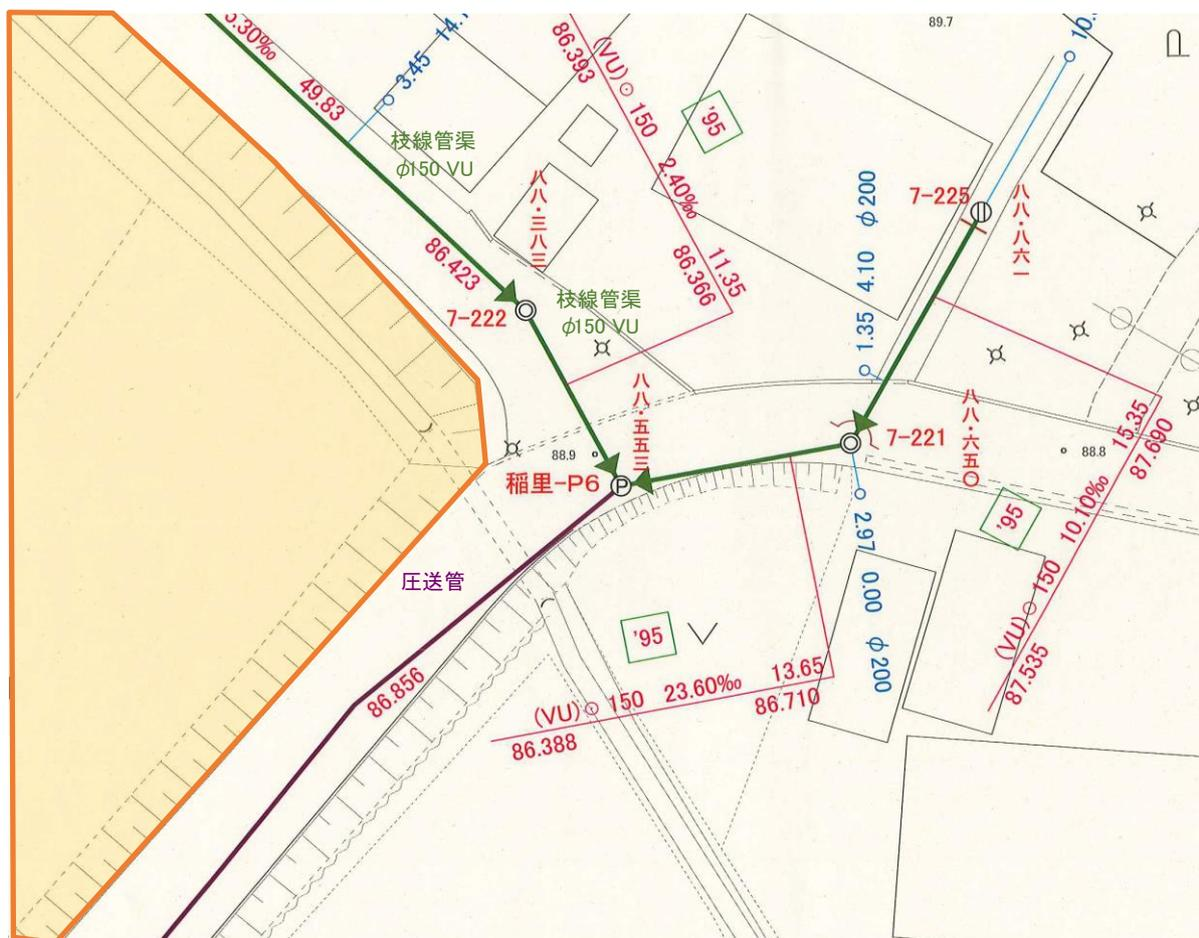
図 建設候補地北東角付近の農業集落排水配管敷設管図
