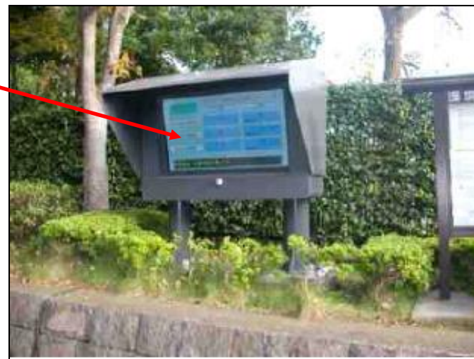
排ガス状況表示盤(一例)
